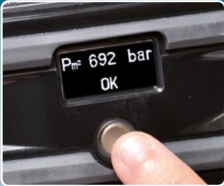
En effleurant le bouton, l'afficheur OLED des nouveaux outils de sertissage 18V Cembre indique en temps réel les éléments suivants:
